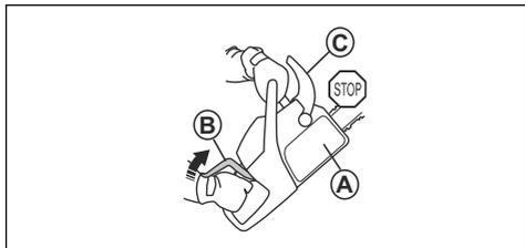
Mueva la protección contra reculadas delantera (C) hacia atrás para desacoplar el freno de cadena.
