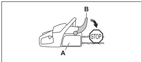
Mueva la protección contra reculadas hacia atrás para desacoplar el freno de cadena.
