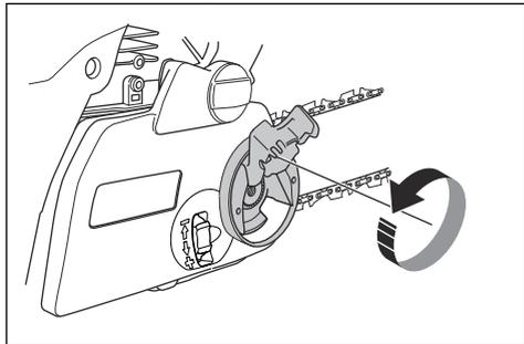
3. Gire la rueda de tensado de la cadena hacia abajo (+) para aumentar la tensión de la cadena de sierra. Gire la rueda de tensado de la cadena hacia arriba (-) para reducir la tensión de la cadena de sierra.
