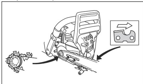
6. Alinee el orificio de la espada con el pasador de ajuste de la cadena e instale la cubierta del embrague.
