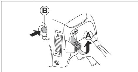
3. Presione la perilla de la bomba de combustible (B) 6 veces aproximadamente o hasta que la perilla se empiece a llenar de combustible. No es necesario llenar completamente la perilla de la bomba de combustible.
