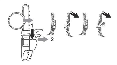
2. Asegúrese de que el corte de indicación inferior sea completamente horizontal y esté en un ángulo de  $90^{\circ}$  con respecto a la dirección de derribo.
