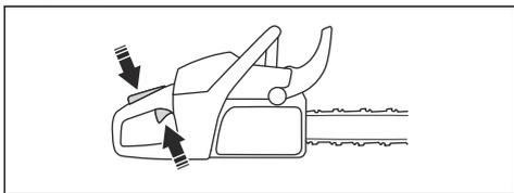
8. Mueva la protección contra reculadas hacia atrás para desacoplar el freno de cadena.
