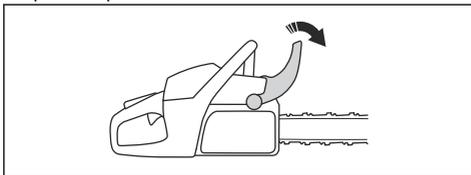
2. Tire del interruptor de arranque/parada (A) hacia afuera y hacia arriba para colocarlo en la posición de estrangulamiento.
