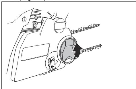
2. Gire la palanca hacia la izquierda para aflojar la cubierta del embrague.
