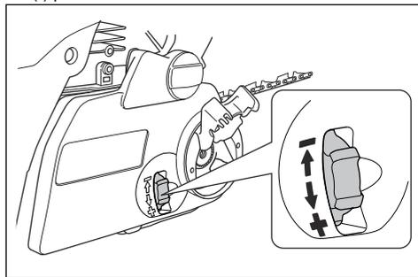
4. Gire la palanca hacia la derecha para apretar la cubierta del embrague.
