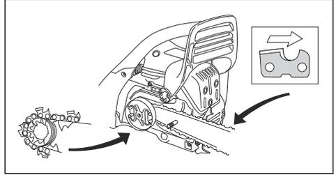
6. Alinee el orificio de la espada con el pasador de ajuste de la cadena e instale la cubierta del embrague.
