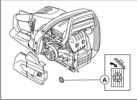
**Nota:** Si la cubierta del embrague es difícil de quitar, apriete la tuerca de la espada, accione el freno de cadena y suéltelo. Se oír un clic si se suelta correctamente.
