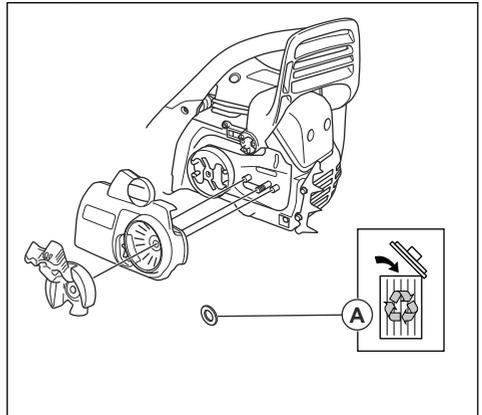
**Nota:** Si la cubierta del embrague es difícil de quitar, apriete la tuerca de la espada, accione el freno de cadena y suéltelo. Se oír un clic si se suelta correctamente.
