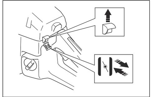
3. Presione la perilla de la bomba de combustible (A) 6 veces aproximadamente o hasta que la perilla se empiece a llenar de combustible. No es necesario llenar completamente la perilla de la bomba de combustible.
