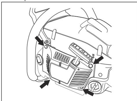
2. Retire el cuerpo del mecanismo de arranque.
