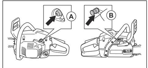
4. Presione la válvula de descompresión (B).
