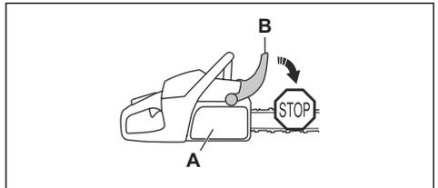
Mueva la protección contra reculadas hacia atrás para desacoplar el freno de cadena.
