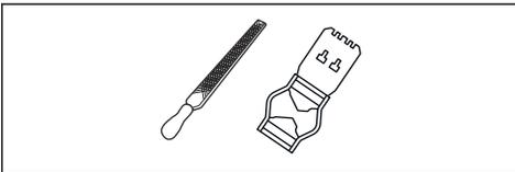
1. Utilice una lima plana y un calibrador de profundidad para ajustar el calibre de profundidad. Utilice solamente el calibrador de profundidad Husqvarna recomendado para obtener el ajuste de calibre de profundidad y el ángulo del calibre de profundidad adecuados.
