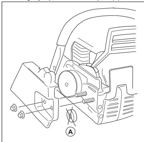
**Nota:** Si la cubierta del embrague es difícil de quitar, apriete la tuerca de la espada, accione el freno de cadena y suéltelo. Se oír un clic si se suelta correctamente.
