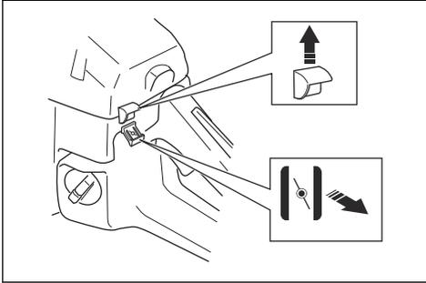
3. Presione la perilla de la bomba de combustible (A) 6 veces aproximadamente o hasta que la perilla se empiece a llenar de combustible. No es necesario llenar completamente la perilla de la bomba de combustible.
