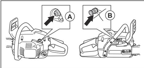
4. Presione la válvula de descompresión (B).
