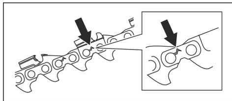
2. Asegúrese de que la cadena de sierra se doble con facilidad. Sustituya la cadena de sierra si está rígida.
