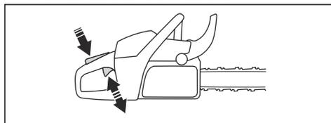
2. Presione el bloqueo del acelerador y asegúrese de que vuelve a su posición inicial al soltarlo.
