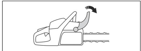
2. Ajuste el estrangulador a la posición de control. De esta manera, el interruptor de arranque/parada se desplazará automáticamente hacia la posición de arranque.
