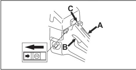
6. Presione la válvula de descompresión.
