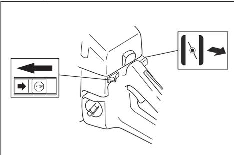
4. Presione el bloqueo del gatillo del acelerador (A).
