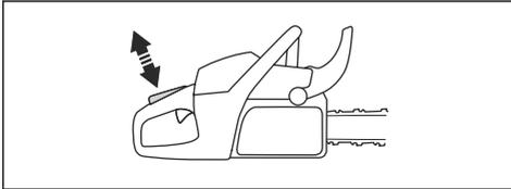
3. Asegúrese de que el acelerador está bloqueado en la posición de ralentí cuando el bloqueo se suelta.
