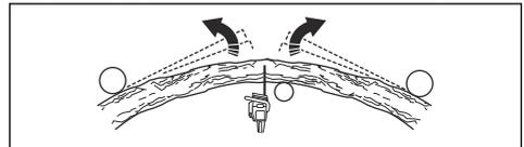
5. Haga uno o varios cortes con una profundidad suficiente para aliviar la tensión. Efectúe un corte en el punto de tensión máxima o cerca del mismo. Asegúrese de que el árbol o la rama se rompan en el punto de tensión máxima.
