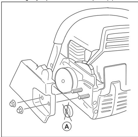
**Nota:** Si la cubierta del embrague es difícil de quitar, apriete la tuerca de la espada, accione el freno de cadena y suéltelo. Se oirá un clic si se suelta correctamente.
