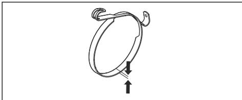
2. Realice una comprobación de la cinta de freno. La cinta de freno debe tener un mínimo de 0,6 mm (0,024 pulg) de espesor en el punto más desgastado.
