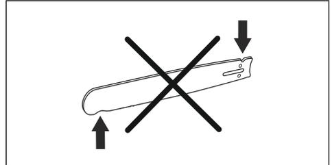
6. Asegúrese de que el cabezal de rueda de la espada gire con facilidad y que su orificio de lubricación no esté obstruido. Limpie y lubrique si es necesario.
