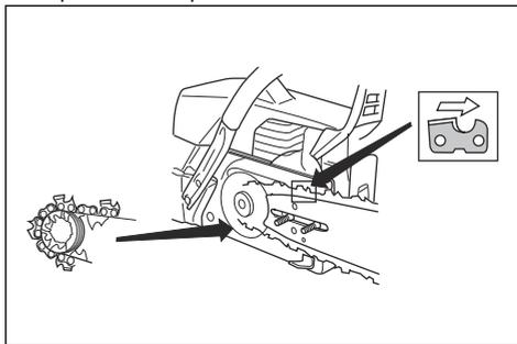
6. Alinee el orificio de la espada con el pasador de ajuste de la cadena e instale la cubierta del embrague.
