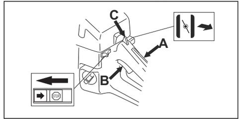
7. Presione la válvula de descompresión.
