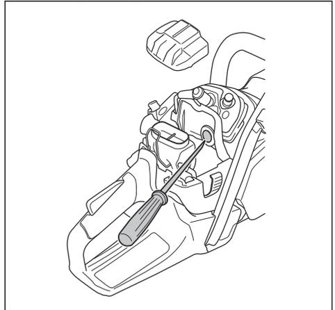
3. Hay disponible una cubierta de invierno para trabajar a temperaturas inferiores a  $-5\text{ }^{\circ}\text{C}$  ( $23\text{ }^{\circ}\text{F}$ ) o con nieve. Monte la cubierta de invierno en el cuerpo del mecanismo de arranque. La cubierta de invierno disminuye el flujo de aire frío y evita la entrada de una gran cantidad de nieve en la zona del carburador.
